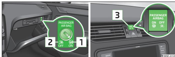
Илл. 170 Выключатель с замком для подушки безопасности переднего пассажира / контрольная лампа отключения/включения подушки безопасности переднего пассажира
