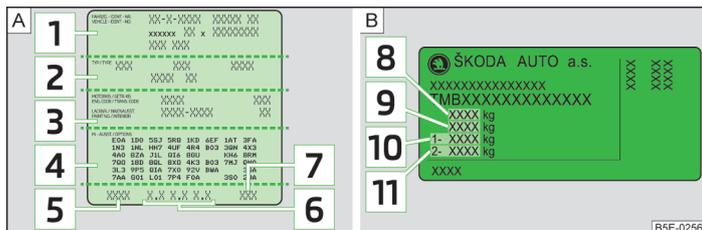
Илл. 236 Табличка с данными автомобиля / заводская табличка
