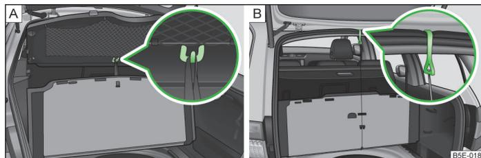
Илл. 85 Закрепление настила пола: Octavia / Octavia Combi
