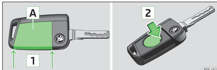
Илл. 207 Снятие крышки / извлечение элемента питания
