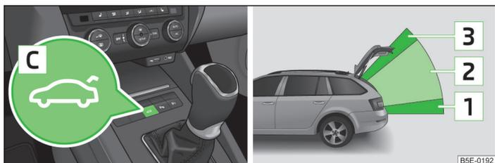
Илл. 22 Управление приводом крышки / зоны управления
