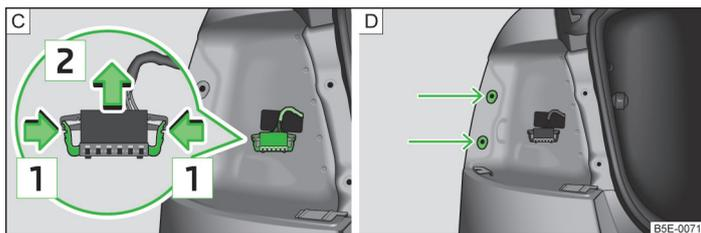
Илл. 230 Установка разъема заднего фонаря / установка заднего фонаря
