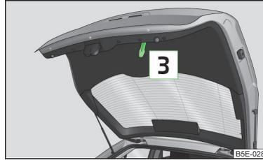
Илл. 20 Ручка в обивке крышки багажного отсека
