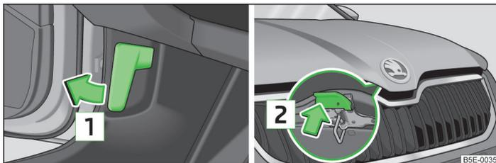
Илл. 180 Рычаг отпирания капота / рычаг отпирания
