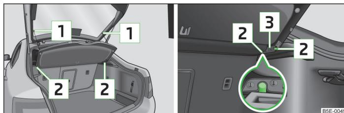
Илл. 87 Снятие / установка полки багажного отсека
