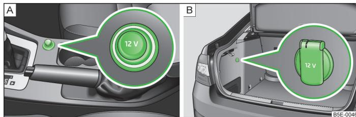
Илл. 66 Розетка 12 В: в передней части центральной консоли/в багажном отсеке.
