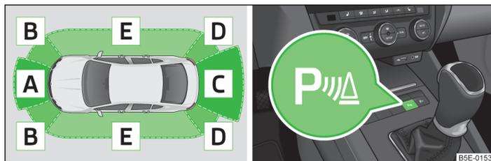
Илл. 129 Дальность действия датчиков / клавиши системы
