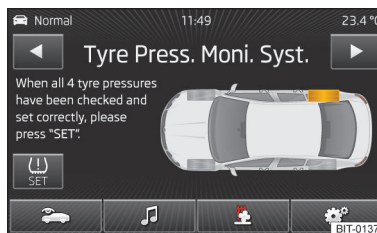
Илл. 27 Индикатор давления в шинах - пример индикации: проверить заднюю правую шину и давление в ней
