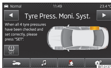
Илл. 46 Индикатор давления в шинах - пример индикации: проверить заднюю правую шину и давление в ней
