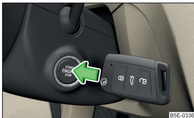
Илл. 136 Запуск двигателя: нажмите кнопку пуска непосредственно ключом
