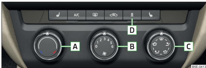
Илл. 128 Органы управления климатической установки с ручным управлением
