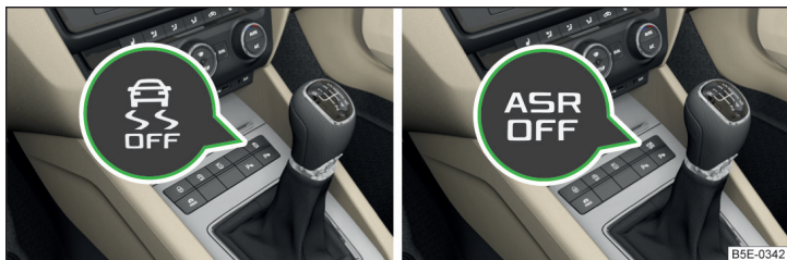
Илл. 146 Клавиша системы: автомобиль с ESC / автомобиль без ESC
