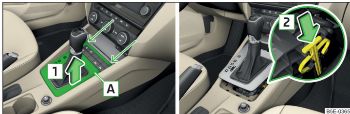
Илл. 228 Аварийная разблокировка рычага селектора
