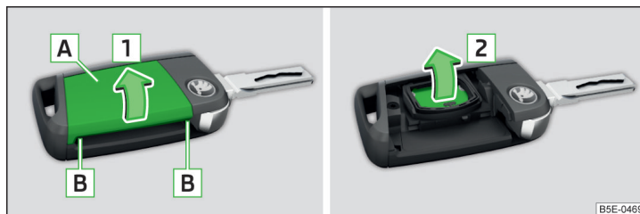
Илл. 223 Снятие крышки / извлечение элемента питания
