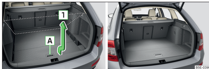
Илл. 118 Перевод трансформируемого пола в верхнее положение / трансформируемый пол в верхнем положении
