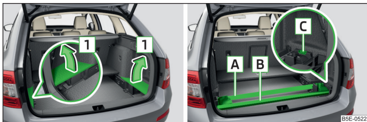
Илл. 126 Снятие боковых накладок багажного отсека / хранение снятого с крыши багажника
