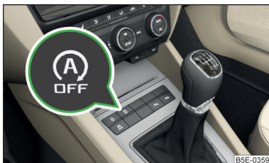
Илл. 138 Кнопка управления системой СТАРТ-СТОП
