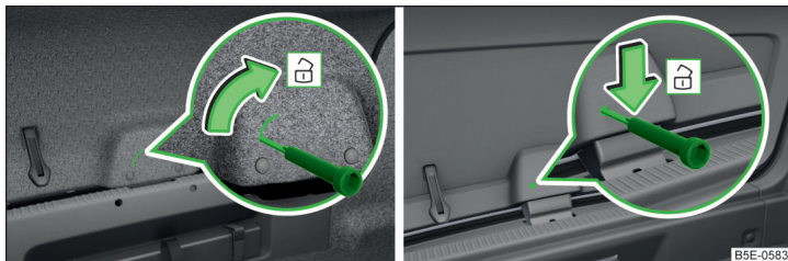
Илл. 227 Отпирание крышки багажного отсека: вариант 1 / вариант 2
