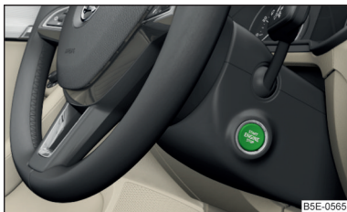
Илл. 135 Кнопка пуска (START ENGINE STOP)
