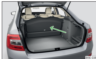
Илл. 111 Укладка полки багажного отсека за спинкой заднего сиденья
