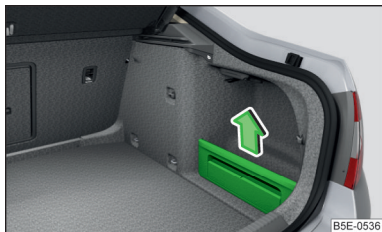
Илл. 114 Извлечение вещевого отсека
