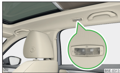
Илл. 61 Задний плафон освещения салона: вариант 3
