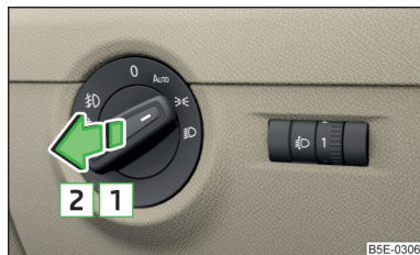
Илл. 57 Переключатель освещения: включение противотуманных фар и заднего противотуман- ного фонаря
