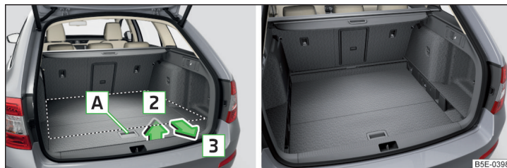
Илл. 119 Перевод трансформируемого пола в нижнее положение / трансформируемый пол в нижнем положении
