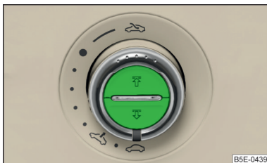
Илл. 51 Элементы управления электропривода солнцезащитной шторки
