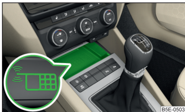
Илл. 86 Отсек для мобильного телефона (Phonebox)
