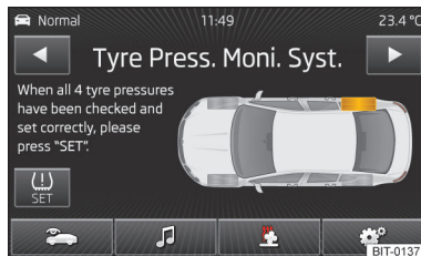
Илл. 46 Пример индикации контроля давления в шинах: система сообщает об изменении давления в задней правой шине
